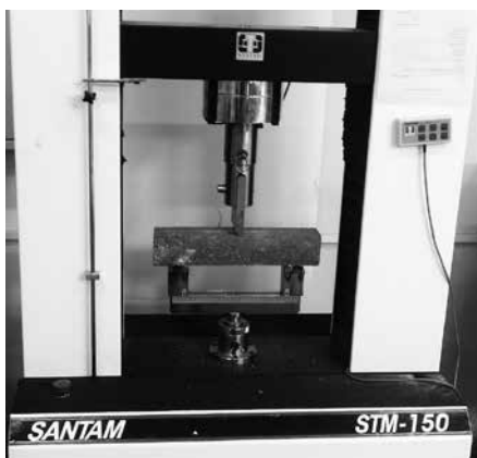
شکل ۴- دستگاه آزمون استحکام خمشی و نحوه قرارگیری نمونه.
