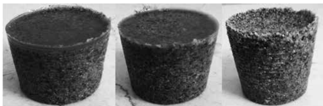
شکل ۱- نمونه های بتن پلیمری ساخته شده با مقادیر وزنی مختلف رزین: (الف) ۲۰٪، (ب) ۲۵٪ و (ج) ۳۰٪.
