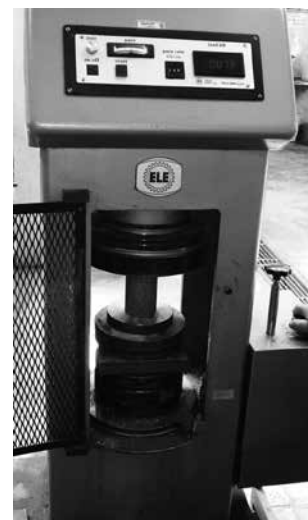
شکل ۳- دستگاه آزمون استحکام فشاری و نحوه قرارگیری نمونه.
