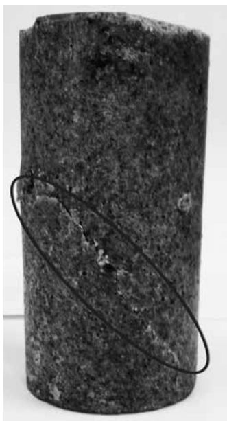
شکل ۷- سطح شکست در نمونه قرار گرفته زیر بار فشاری.
