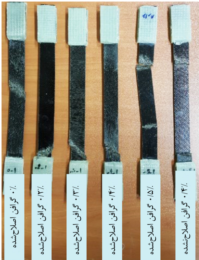
شکل ۱- نمونه‌های نانوکامپوزیت اپوکسی-الیاف بازالت-گرافن پس از آزمون کشش.
