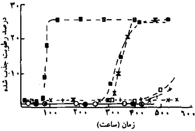
شکل ۳- درصد رطوبت جذب شده بر حسب مدت زمانی که فیلم پلیمری در آن بوده است: (—) خشک، (----) رطوبت ۱۰۰% و (.....) استیک اسید یک مولار و در دماهای ۵۰ (O, X, O) و ۷۰ (●, +, ●) و ۹۰°C (●, X, ●)
