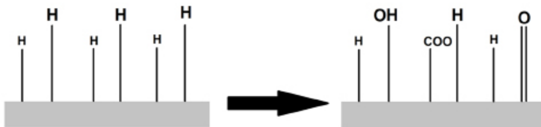
شکل ۶- طرح کلی سازوکار اصلاح سطح جداکننده پلی اتیلنی با استفاده از پلاسمای اکسیژن.
