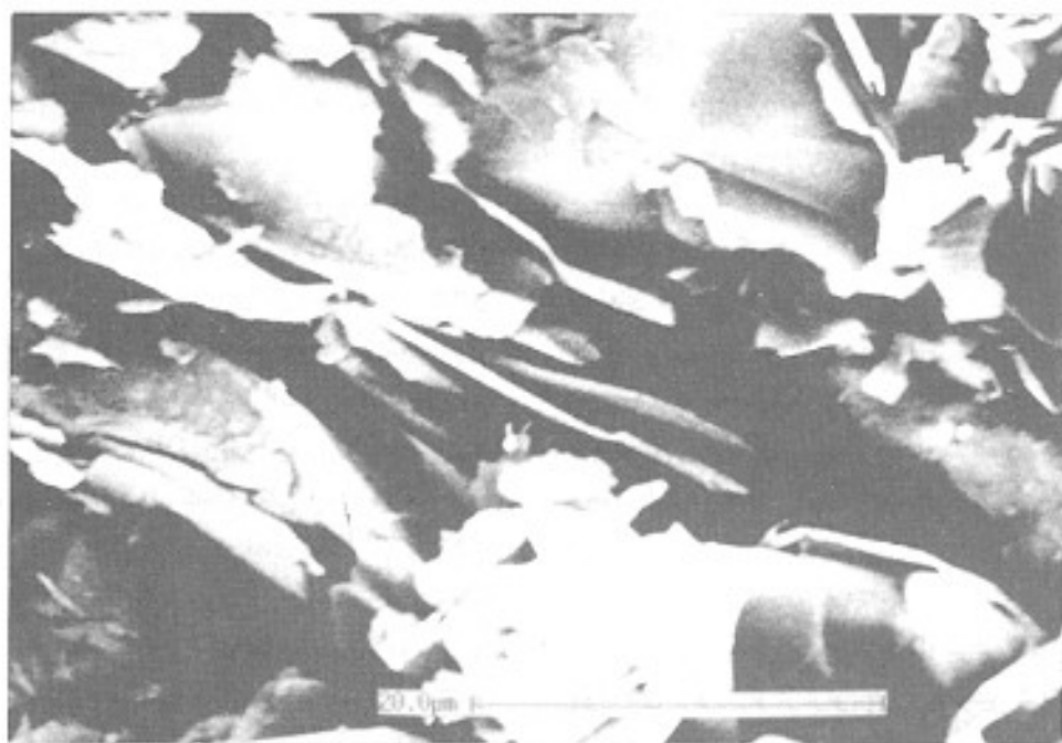
شکل ۷. عکس SEM از چگونگی فرار گرفتن پولکهای گرافیت و دانه‌های منیزیت با پیوند دهنده رزینی که در آن نواحی روشن به منیزیت و نواحی تیره به کربن مربوط است [۱۴].
