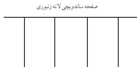
(الف) ساختار ساندویچی لانه زنبوری گرمانرم قبل از اعمال فشار.
