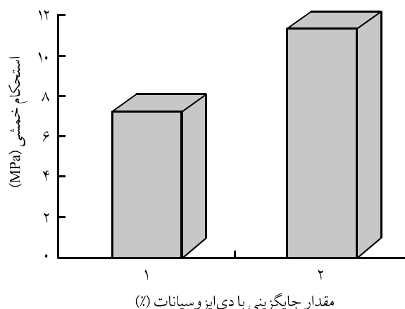
شکل ۵- اثر مقدار جایگزینی بادی ایزوسیانات بر استحکام خمشی.
